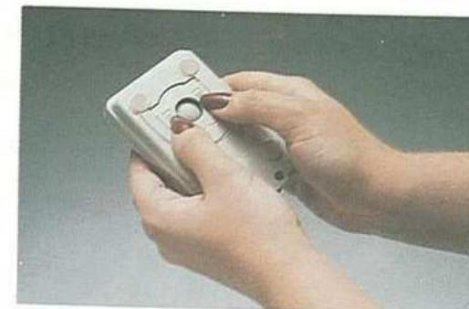
Avec vos pouces, poussez fermement dans la direction des flèches pour ouvrir le boîtier de la bille. La souris étant toujours retournée, soulevez le couvercle avec un ongle :
