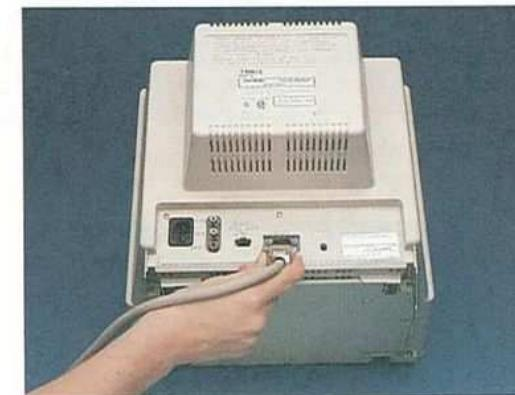
Enfoncez le bout large du câble dans le *connecteur RVB* situé à l'arrière de l'AMIGA :
